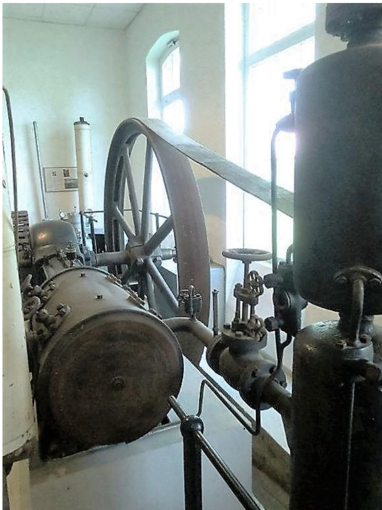
Der liegende Tandemverdichter ist mit allem Zubehör ausgestattet, er kann sogar mit Druckluft in Betrieb gesetzt werden.
