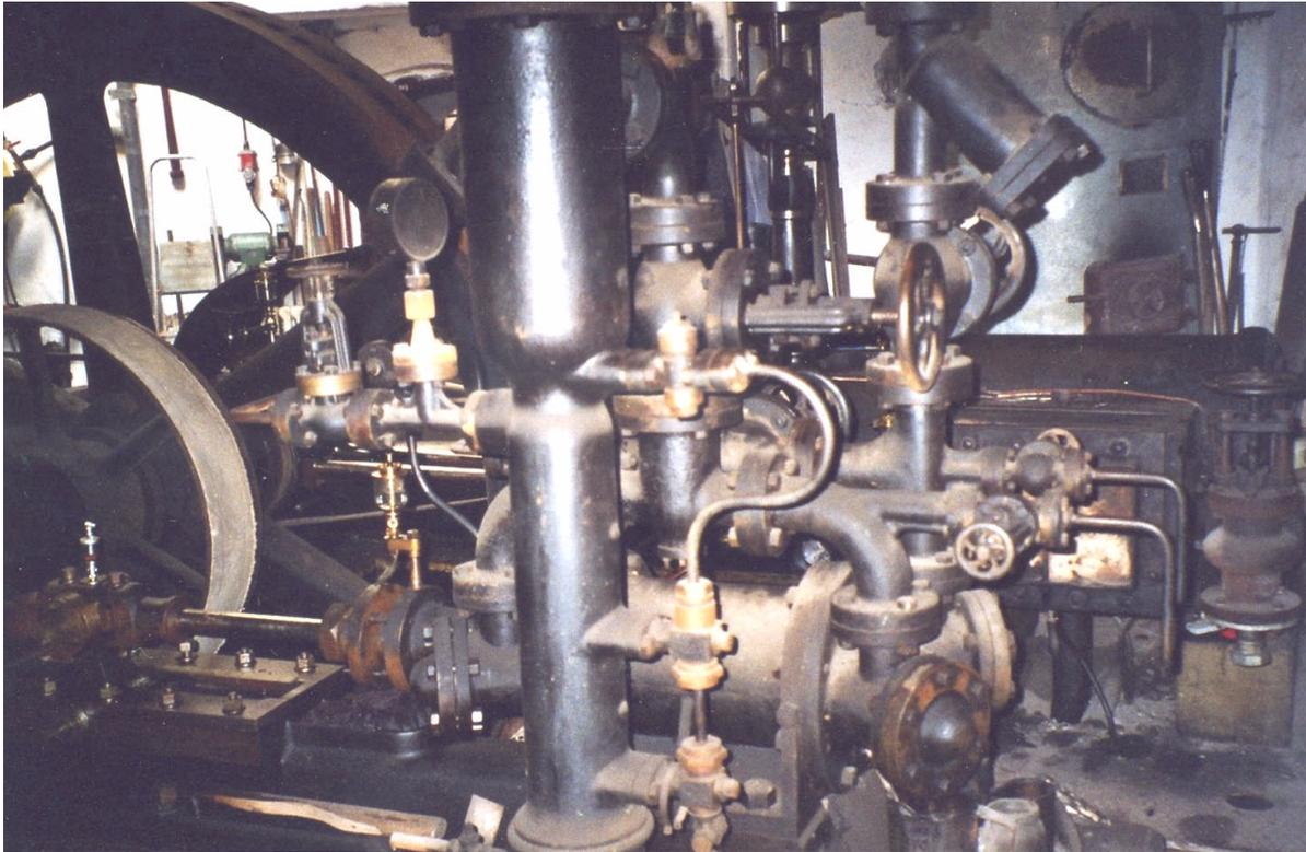
Der Verdichter wird durch eine Dampfmaschine angetrieben, die gleichzeitig aber auch noch einen Generator zu Stromerzeugung antreibt.
