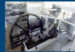
27570 Bremerhaven, Morgenstern-Museum doppelwirkende liegende Zwillingsmaschine von Wegelin und Hübner, Baujahr 1929 www.historisches-museum-bremerhaven.de
