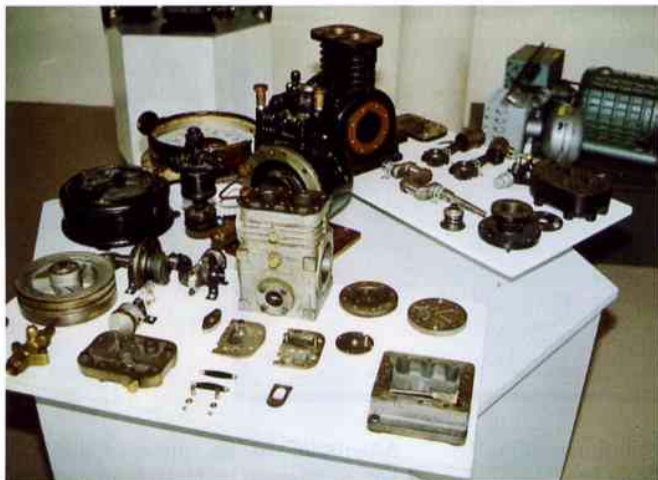
Fein sortierte und aufbereitete Komponenten von Hubkolbenverdichtern der mittleren Zeit-Generation im Frigotheum. Das macht viel (ehrenamtliche) Arbeit
