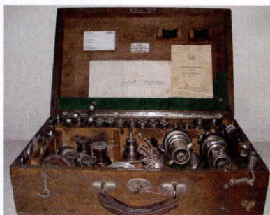
Maihak-Indikator zur Aufzeichnung des Druckverlaufs im Zylinder von Kolbenmaschinen
